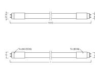
Technische Daten Osram LED Röhre T8 (UN) Standard Output 24W 2550lm - 830 Warmweiß | 150cm - Ersatz Für 58W
