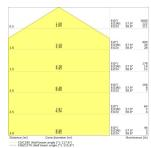
Technische Daten Ledvance LED Röhre T9 Value rund (EM/Mains) 11W 1320lm - 865 Tageslichtweiß | Ersatz für 22W
